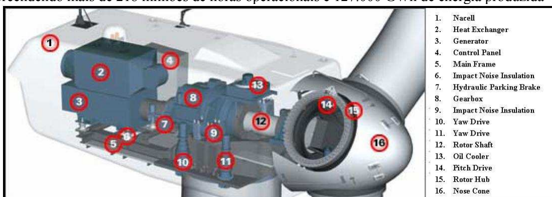
Figura 3. Esquema da turbina nacell GE Eólica, tipo GE 1.6xle
